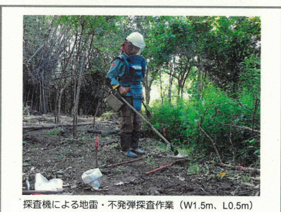
探査機による地雷・不発弾探査作業(W1.5m、L0.5m)
